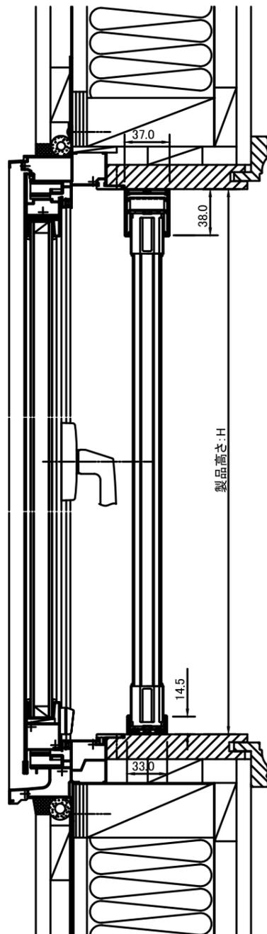
インテリア網戸 側面付 片引き(20mm)横断面図
